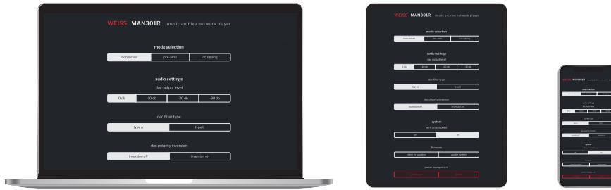
メイン画面では以下の3つの操作モードの切り替え、アナログ出力レベルの調整等のオーディオ設定、Wi-Fi接続設定、ファームウェアの更新、電源シャットダウンや再起動を行ないます。
